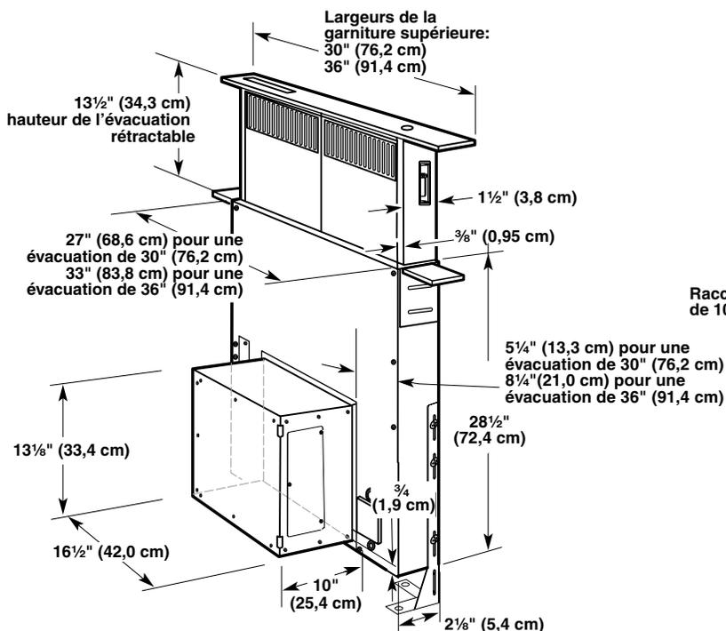
Modèles à ventilateur monté à l'extérieur
