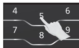
Entrer la durée de cuisson à l'aide des **touches numériques**. Le temps de cuisson maximal de la puissance P10 (ÉLEVÉE) est de 30 minutes. Le temps de cuisson maximal des autres puissances est de 99 minutes, 99 secondes.
