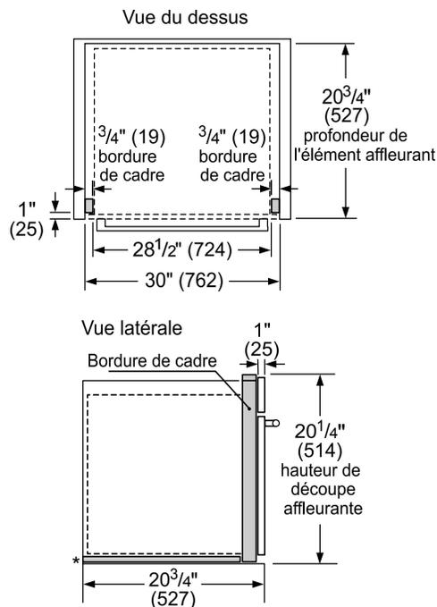
\* Un montage affleurant requiert une plaque de base de  $\frac{5}{16}$ " (8 mm) de hauteur x  $28\frac{1}{2}$ " (724 mm) de largeur x  $19\frac{3}{4}$ " (500 mm) de profondeur sous le boîtier de l'unité.
