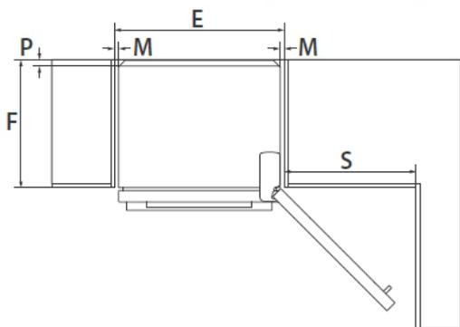
Porte du réfrigérateur au même niveau que l'armoire – ouverture de la porte à 90°
