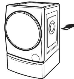
9. Placer un niveau sur la partie supérieure de la laveuse et la sècheuse Tout-en-un et contrôler l'aplomb d'avant en arrière et latéralement.
