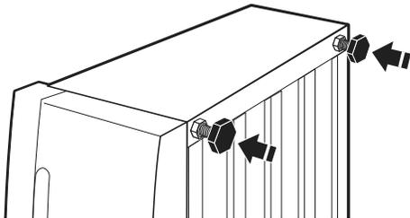
4. Visser les boulons dans le bas de la laveuse et la sécheuse tout-en-un.
