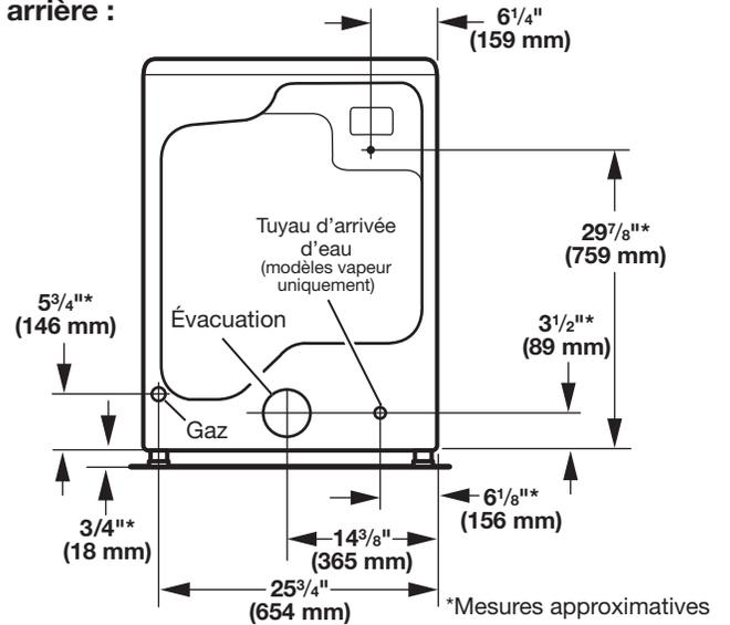
**REMARQUE :** La plupart des installations requièrent un espace minimum de 5" (127 mm) derrière la sécheuse pour le conduit d'évacuation avec coude. Voir "Exigences concernant l'évacuation."
