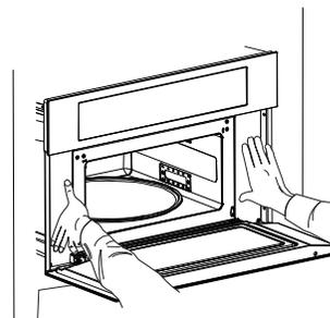
3. À l'aide d'un foret de 1/8" (3,2 mm), percer des avant-trous dans les glissières de montage situées de chaque côté du four à micro-ondes.
