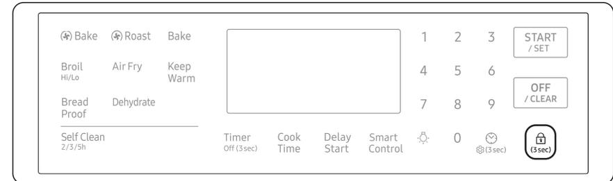
Appuyez sur **1 (3sec)** pendant 3 secondes pour verrouiller ou déverrouiller simultanément le tableau de commande et la porte. Lorsque la fonction Verrouillage du four est activée, le tableau de commande du four ne fonctionne pas et la porte du four est verrouillée et ne peut pas être ouverte.
