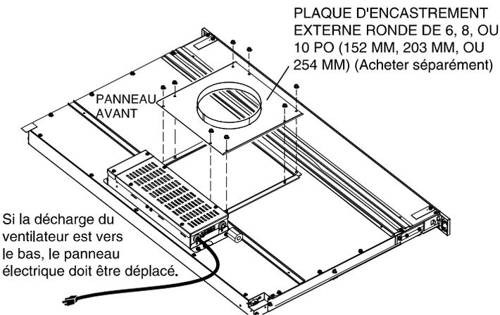
Si la décharge du ventilateur est vers le bas, le panneau électrique doit être déplacé.
