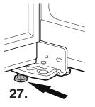
27. Placer l'appareil à son emplacement dans sa position définitive. Dévisser le pied réglable au support inférieur jusqu'à ce qu'il repose au sol, puis le dévisser encore de 90°.
