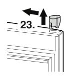
**23.** Pousser le bouchon à l'aide d'un tournevis et l'enfoncer sur le côté opposé.
