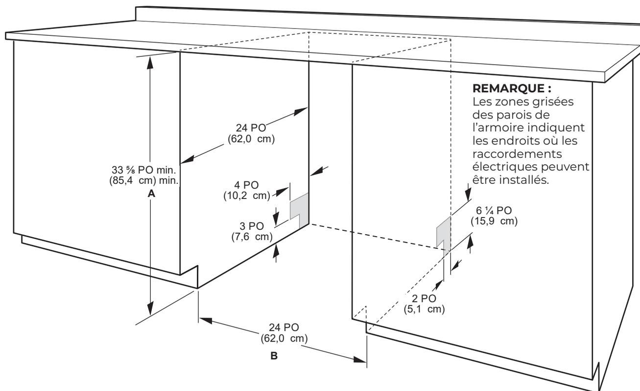
A. Mesure depuis le point le plus bas de la face inférieure du comptoir. Cette dimension peut être réduite à 33 5/8 po min. (85,4 cm) min. en retirant les pieds du lave-vaisselle et en perforant l'isolant (couverture isolante) de l'appareil.
