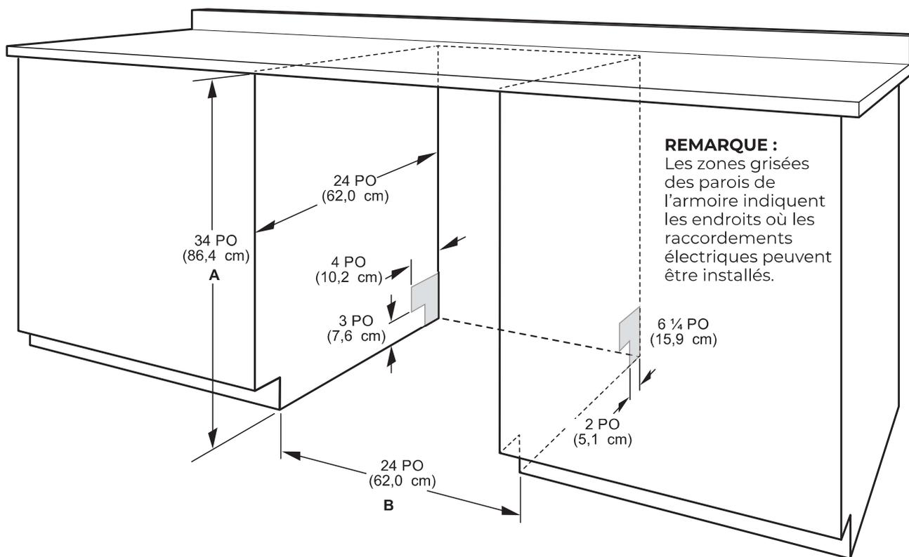
A. Mesure depuis le point le plus bas de la face inférieure du comptoir. Cette dimension peut être réduite à 33 1/2 po (85,1 cm) en retirant les roulettes du lave-vaisselle et en perforant l'isolant (la plaque d'insonorisation) de l'appareil.
