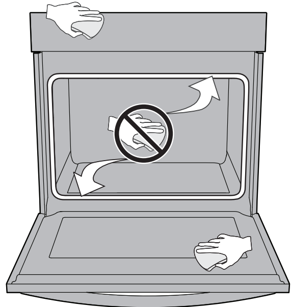
Figure 4: Nettoyer le pourtour du joint de la porte du four
