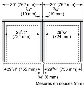
IMPORTANT : Lors de l'installation d'un four en combinaison, une distance minimale entre les fours est requise. Consulter le manuel d'installation du four pour toutes les autres mesures.
