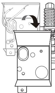
**5** Insérez un serre-câbles **2** dans la boîte de jonction en le faisant passer par le trou. Serrez l'écrou à œil **3** pour le fixer.
