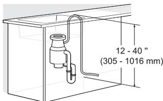
**Raccordement à un broyeur sans coupure antirefoulement**
