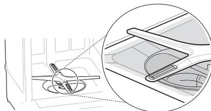
Après avoir enlevé le panier inférieur, placez un niveau sur la paroi intérieure de la cuve pour vérifier que le lave-vaisselle est de niveau en largeur.
