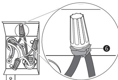
**10** Repliez les fils connectés dans la boîte de jonction et vissez le couvercle de la boîte de jonction.
