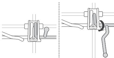
**2** Repérez la rainure de fixation ❶ sur le panier à tasses, alignez-la avec la barre de soutien et retirez fermement le panier de la barre de soutien de ce côté-là.
