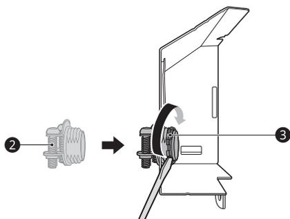
**6** Insérez le câble électrique dans le trou du serre-câbles. Serrez les deux vis pour fixer le câble.
