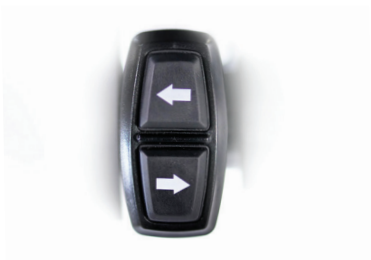
MÉCANISME DES CLIGNOTANTS GAUCHE ET DROIT
