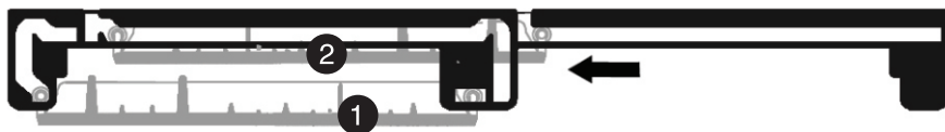
Support gauche ajusté à la position inférieure et support droit déplacé vers la gauche
