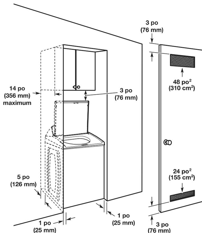
Les dimensions représentent les dégagements recommandés permis, hormis pour les ouvertures de ventilation de la porte de l'armoire qui correspondent aux dimensions minimales nécessaires.
