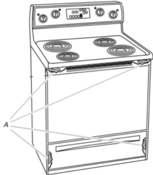
A. La placa que indica modelo/serie/valores nominales está ubicada en el marco detrás de una esquina superior de la puerta o en alguno de los costados del cajón.
