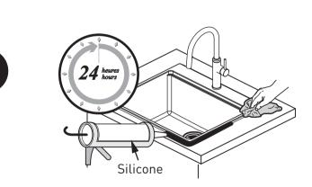
Installation sous plan *Undermount installation*
